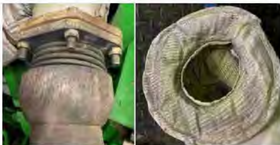
Cr-6 Ablagerungen auf einem Kompensator (gelbliches Pulver)
