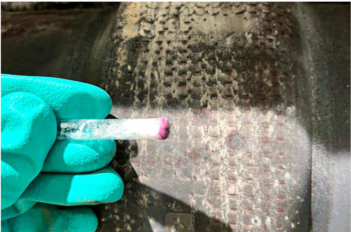
Hoge concentratie calciumchromaat op bijna alle hete motoronderdelen van een gasmotor (Afb. 44)
