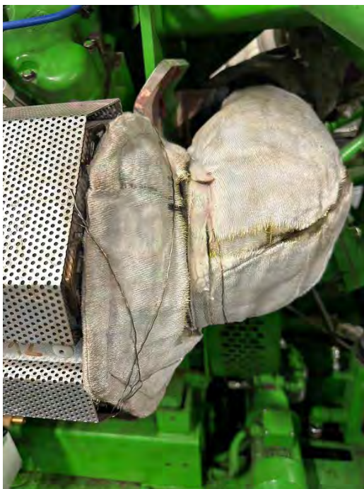
Fig.47: Chromaten op het oppervlak van textielisolatieFig.
