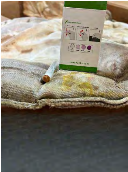
Fig. 60-64: Chromaatafzettingen op isolerende matrassen
