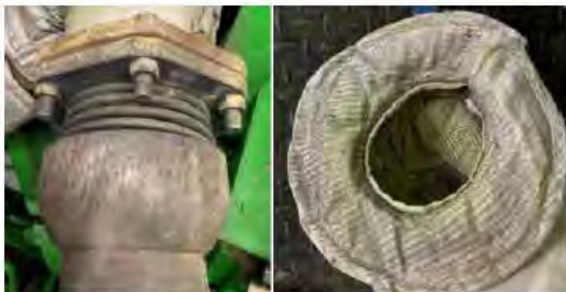
Cr-6 Ablagerungen auf einem Kompensator (gelbliches Pulver)
