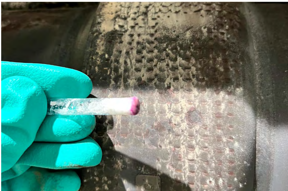
Hohe Calciumchromatkonzentration auf fast allen Motorenheißteilen eines Gasmotors (Abb.44)
