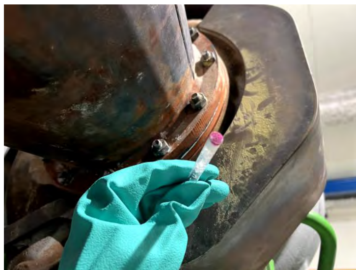
Abb.3: positiver Cr(VI)-Schnelltest nach Abisolierung eines Turboladers
