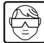
Bei Überkopfarbeiten Schutzbrille tragen
