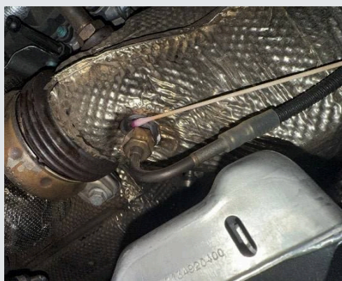
Positive Chrom(VI) -Schnelltests im Motorraum von Pkw.
