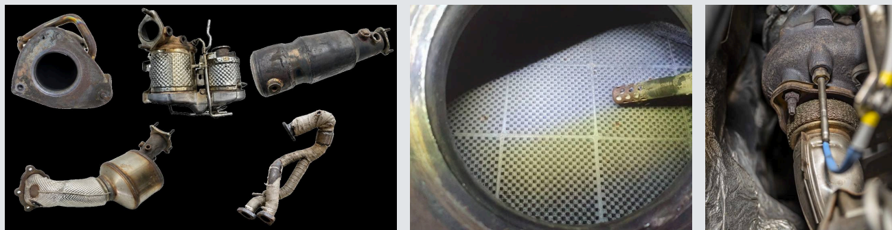
Typische Alteile aus der Abgasstrecke; gelbliche Beläge am Partikelfilter; Sensor mit Ablagerungen am gedämmten Abgasrohr.
