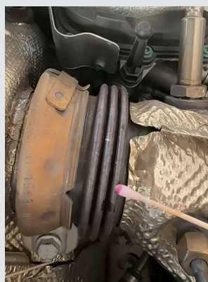
Positive Chrom(VI) -Schnelltests im Motorraum von Pkw.
