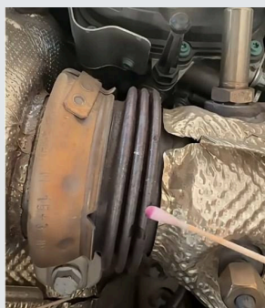
Positive Chrom(VI)-Schnelltests im Motorraum von Pkw: Kompensator am Abgasrohr, Flanscbereich unter dem Heatshield, Abgasrohr neben Leitungen und Halterungen.
