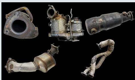
Typische Altteile aus der Abgasstrecke; gelbliche Beläge am Partikelfilter; Sensor mit Ablagerungen am gedämmten Abgasrohr.
