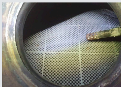
Typische Altteile aus der Abgasstrecke; gelbliche Beläge am Partikelfilter; Sensor mit Ablagerungen am gedämmten Abgasrohr.
