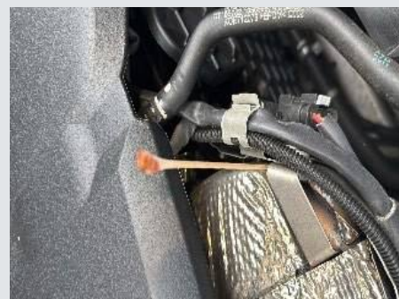
Positive Chrom(VI)-Schnelltests im Motorraum von Pkw: Kompensator am Abgasrohr, Flanscbereich unter dem Heatshield, Abgasrohr neben Leitungen und Halterungen.
