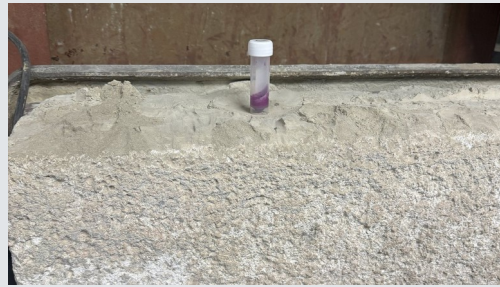
Lose Ascheauflage an einem Bauteil im Ofenbereich. Nachweis an Asche im Ofenbereich, Probenröhrchen mit Farbumschlag.
