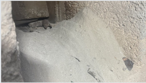
Lose Ascheauflage an einem Bauteil im Ofenbereich. Nachweis an Asche im Ofenbereich, Probenröhrchen mit Farbumschlag.
