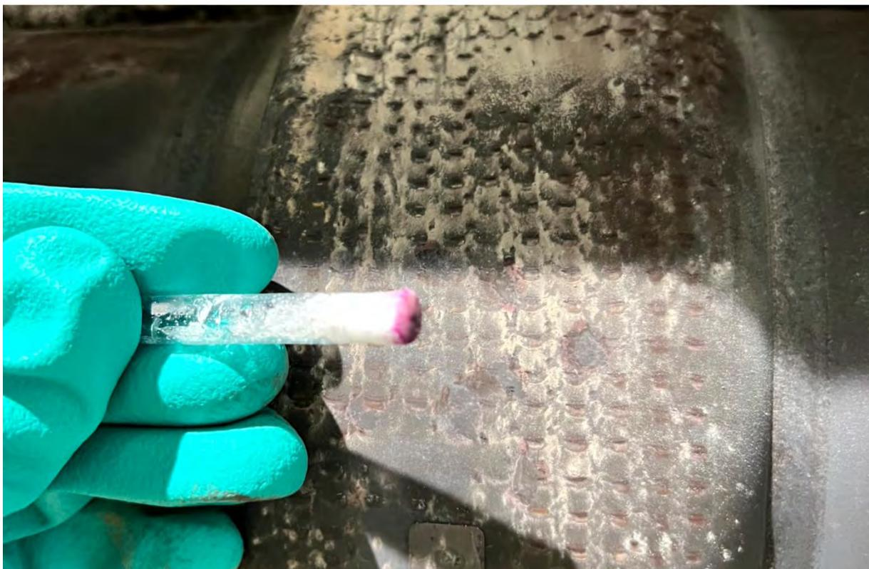
Hohe Calciumchromatkonzentration auf fast allen Motorenheiteilen eines Gasmotors (Abb.44)
