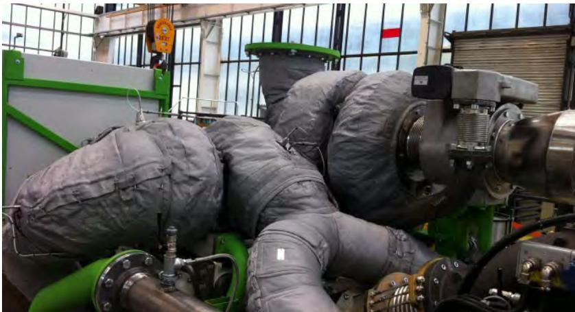
Abb12: Motorenisolierung mit Isoliermatten
