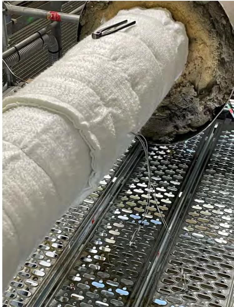
Abb.79: calciumfreie Kontaktschicht
