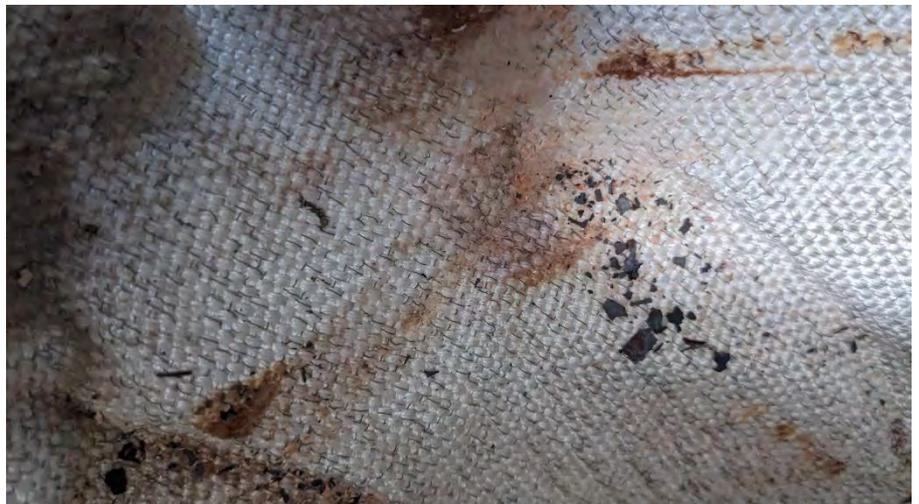
Auch aus den Isolierelementen gelöste Glasfasern zeigen Chromatkontaminierung, obwohl keine gelblichen Stäube erkennbar sind. (Abb.42)
