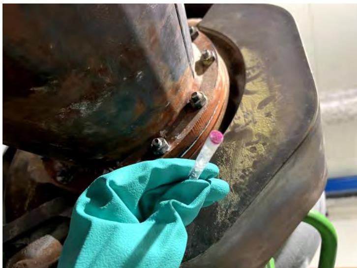
Abb.3: positiver Cr(VI)-Schnelltest nach Abisolierung eines Turboladers
