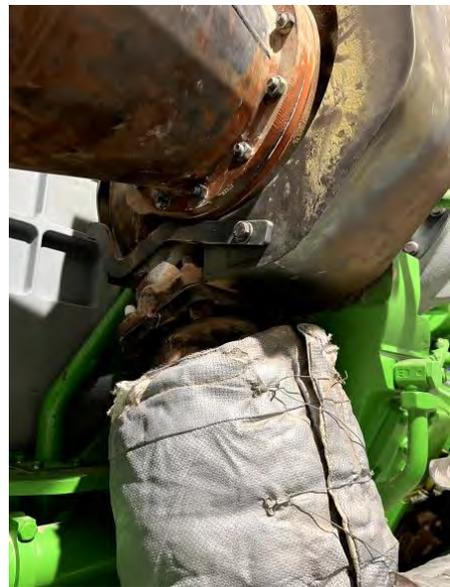
Abb.2: abisolierter Turbolader
